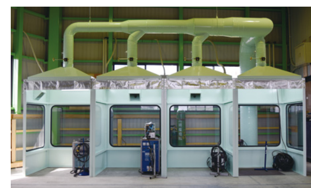
4基の溶接作業ブース
